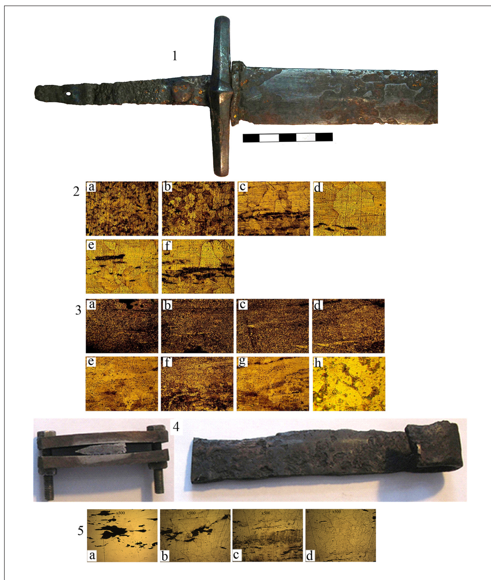
Рис. 5. Сабля №3, фрагмент клинка №4 и увеличенные фрагменты шлифов.
